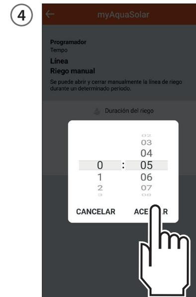
Deslice las cifras de las horas y los minutos hasta llegar a la duración deseada y confirme. La duración del riego puede ajustarse desde 1 minuto hasta 3 horas y 59 minutos.
