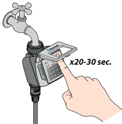
Si el programador se comporta de manera anormal, es posible reiniciarlo. El reset NO eliminará los programas configurados, ni tampoco la fecha y la hora, sino que se limitará a reiniciar la tarjeta electrónica.
