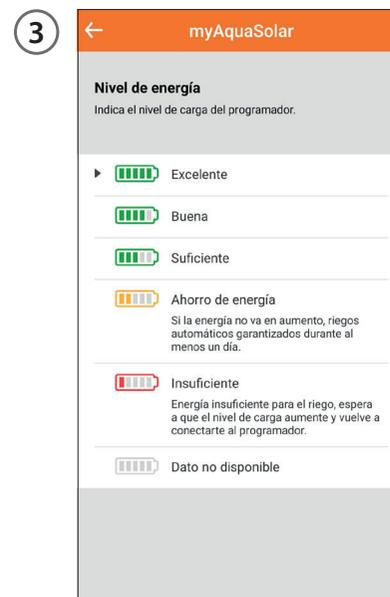
Si el icono del nivel de energía está en gris, espere a que termine la carga (PRIMERA O NUEVA ACTIVACIÓN). Hay 5 niveles de energía. Si el nivel de energía entra en **ahorro de energía** (icono amarillo), el programador seguirá garantizando los riegos automáticos durante 1 día como mínimo. En caso de **energía insuficiente** (icono rojo), se deshabilitarán todas las funciones, manteniendo memorizadas la fecha y la hora durante un mínimo de 16 horas antes del apagado.
